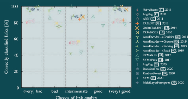
Slika: Empirična primerjava zmogljivosti izbranih ocenjevalnikov kakovosti brezžičnih povezav.
