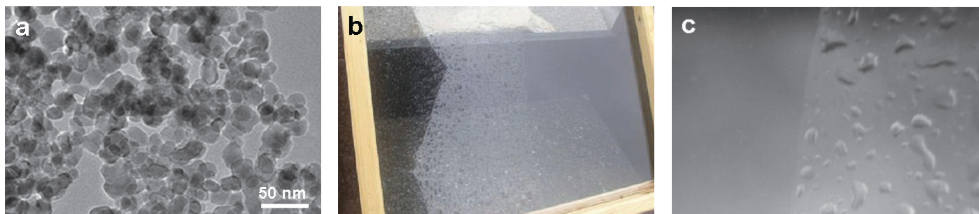
(a) TEM posnetek sintetiziranih anatasnih nanodelcev, (b) stekleni substrat s samočistilnim nanosom na osnovi \text{TiO}_2 , (c) prikaz hidrofilnega efekta
