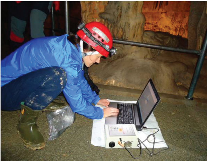
Izpisovanje podatkov z merilnega instrumenta za meritve koncentracije radona v Postojnski jami Printing the data from a measuring instrument for measuring radon concentrations in the Postojna Cave
