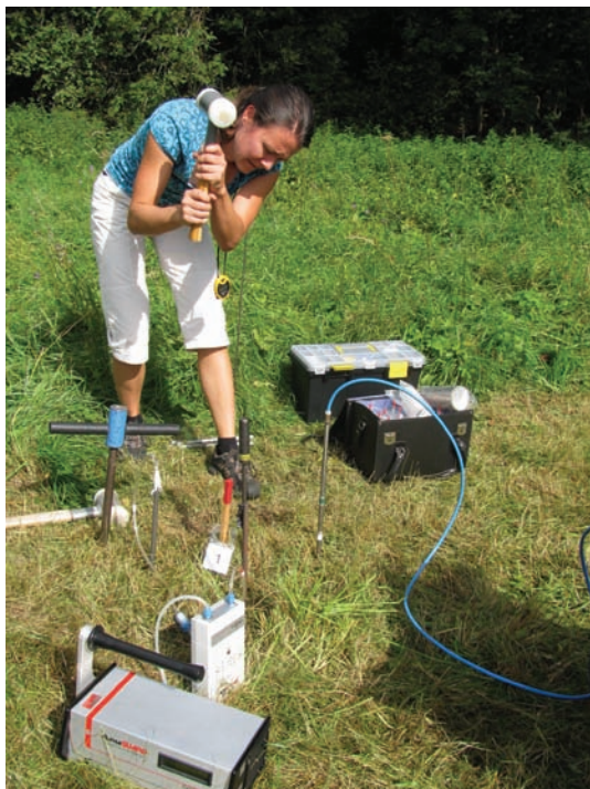
Terensko delo – meritve koncentracij radona v talnem zraku
