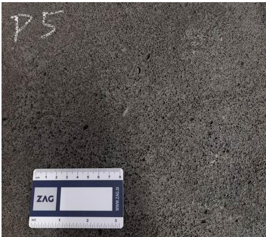
Slika 50. Slika plošče sestave P5, 40 cm × 40 cm × 5 cm.
