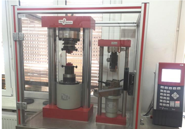
Slika 6. Univerzalni stroj ToniNORM za meritev upogibne ter tlačne trdnosti vzorcev.
