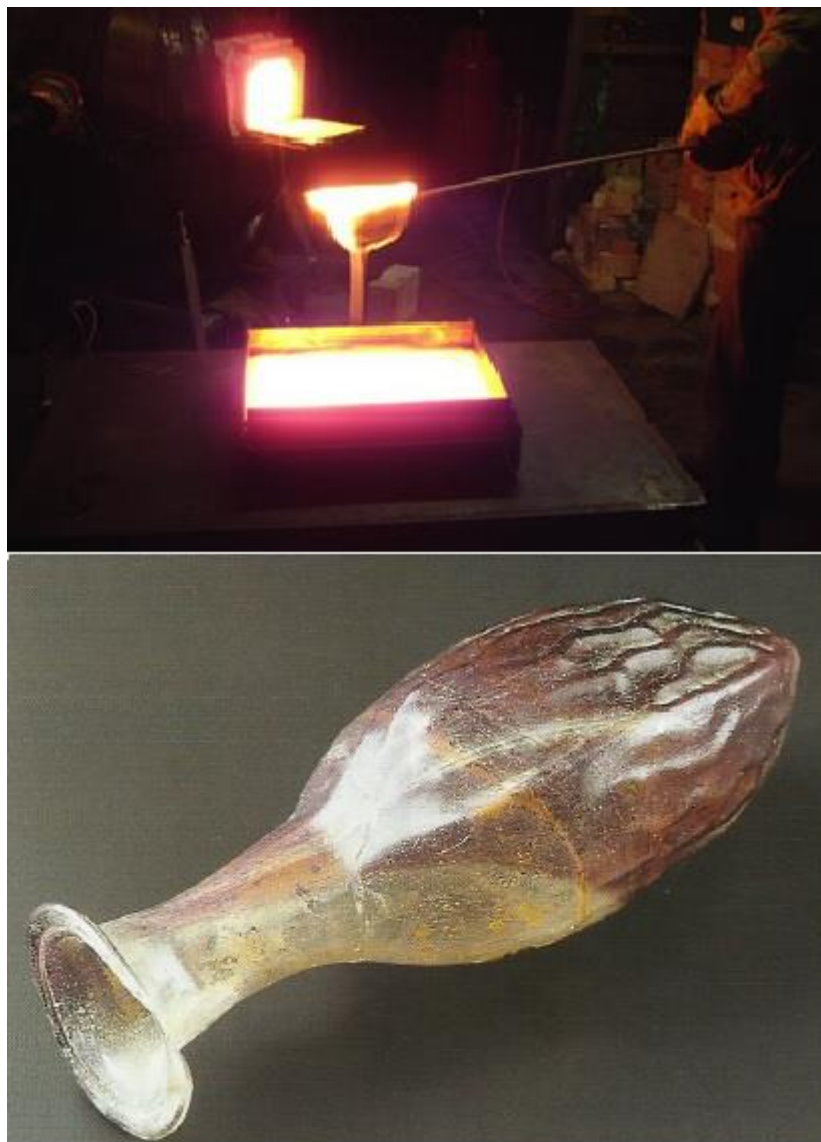
Slika 18: Ulivanje stekla v kalup in balzamarij, ki je bil izdelan s tehniko pihanja v kalup [22].
