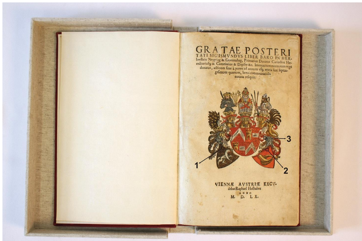
Slika 65: Meritev PIXE v točkah 1–3 na naslovni strani [175].
