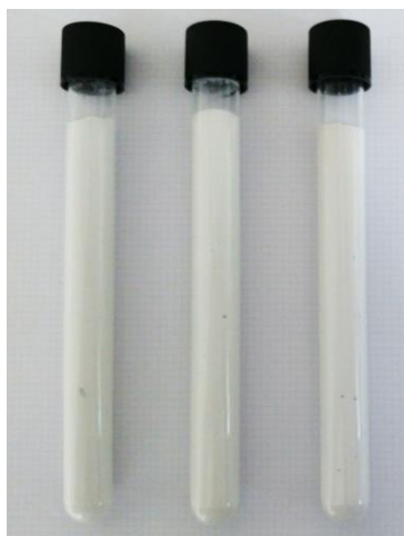
Slika 5.4: Neprodušno zaprti vzorci malt in cementnih past v epruvetah, s katerimi smo simulirali pogoje, s katerimi se malte srečujejo v notranjosti zidu. Apno se zveže počasi zaradi pomanjkanja \text{CO}_2 , malta pa se ne suši, ker voda ne izpareva.
