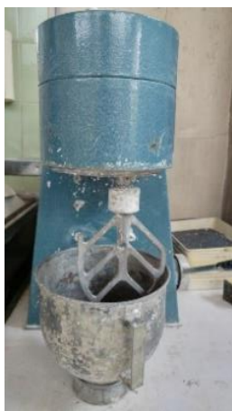
Slika 5.2: Standardni mešalec, ki smo ga uporabili za pripravo vzorcev.
