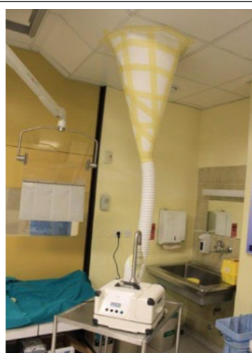
Slika 13: Coriolis ciklonski vzorčevalnik zraka in neposreden dotok zraka iz prezračevalnega sistema. (Pintarič, 2015)
