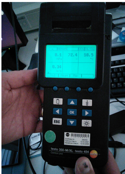
Slika 10: Testo 454 elektronski merilec pretoka zraka. (Pintarič, 2015)
