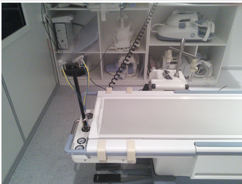
Slika 7: OPTI-JET CS MD 1, testiranje pravilnega kota dvosistemskih šob. (Pintarič, 2015)
