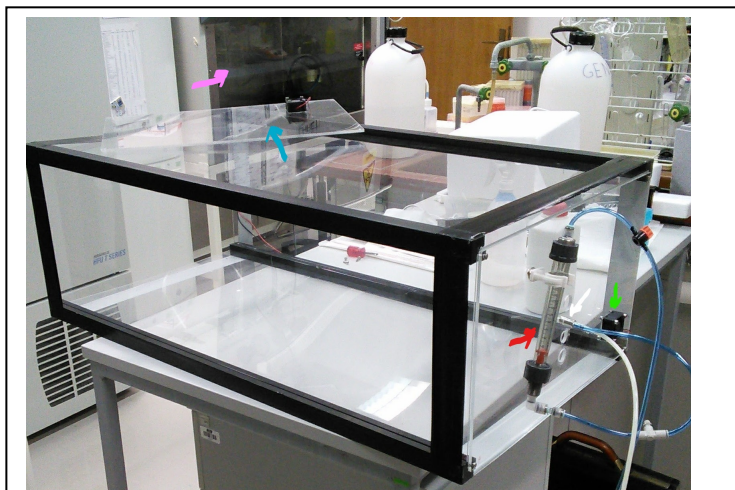
Slika 17: Simulacijska komora za hladno zamegljevanje pred uporabo v digestoriju. (Pintarič, 2018)
