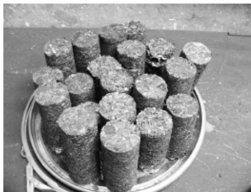
Figure 3: Compacts of stainless steel chips after cold pressing Slika 3: Stisnjeni ostružki nerjavnega jekla po hladnem stiskanju
