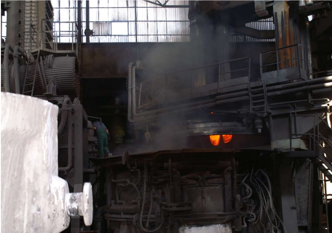
Slika 2: Pridobivanje jekla v elektroobločni peči (slikano v podjetju Štore Steel d.o.o.).
