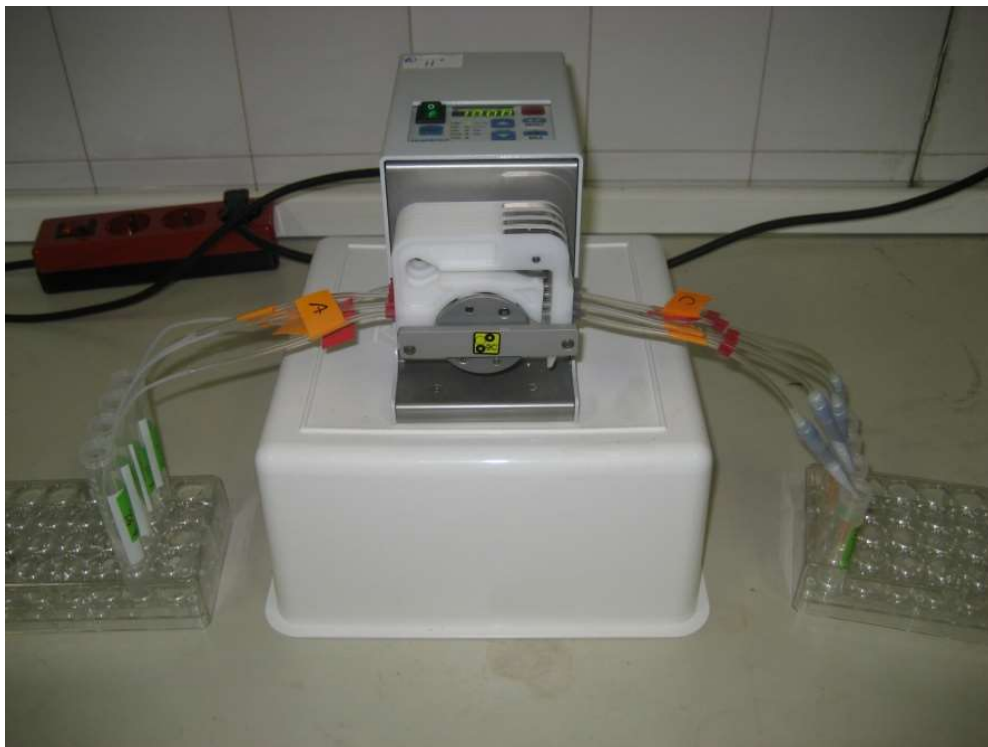
Slika 8: Sistem kolon, napolnjenih s kelatno smolo Chelex-100, ki smo jih uporabili za odstranitev matrice vzorca morske vode.
