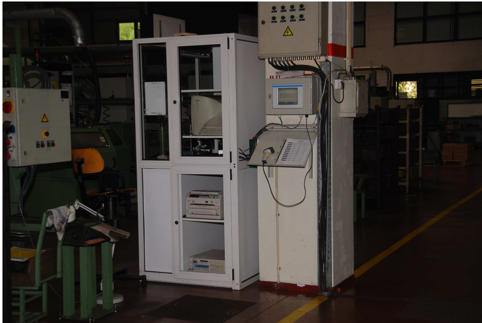
Slika 2.4: Informacijski terminal (proizvajalec Kolektor Synatec [36]). Terminal je nameščen na stebru znotraj proizvodnega obrata. Lega terminala je določena tako, da je dostopen z več različnih delovnih mest.
