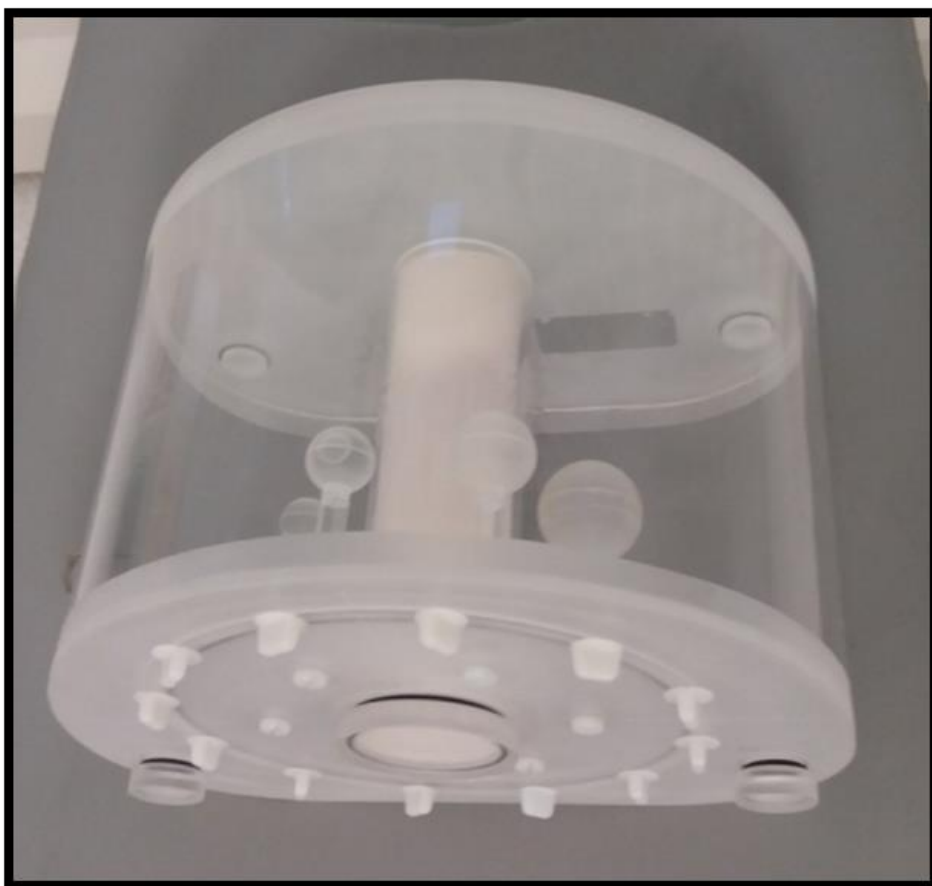
Slika 3: NEMA body fantom za izvajanje analiz na PET/CT.
