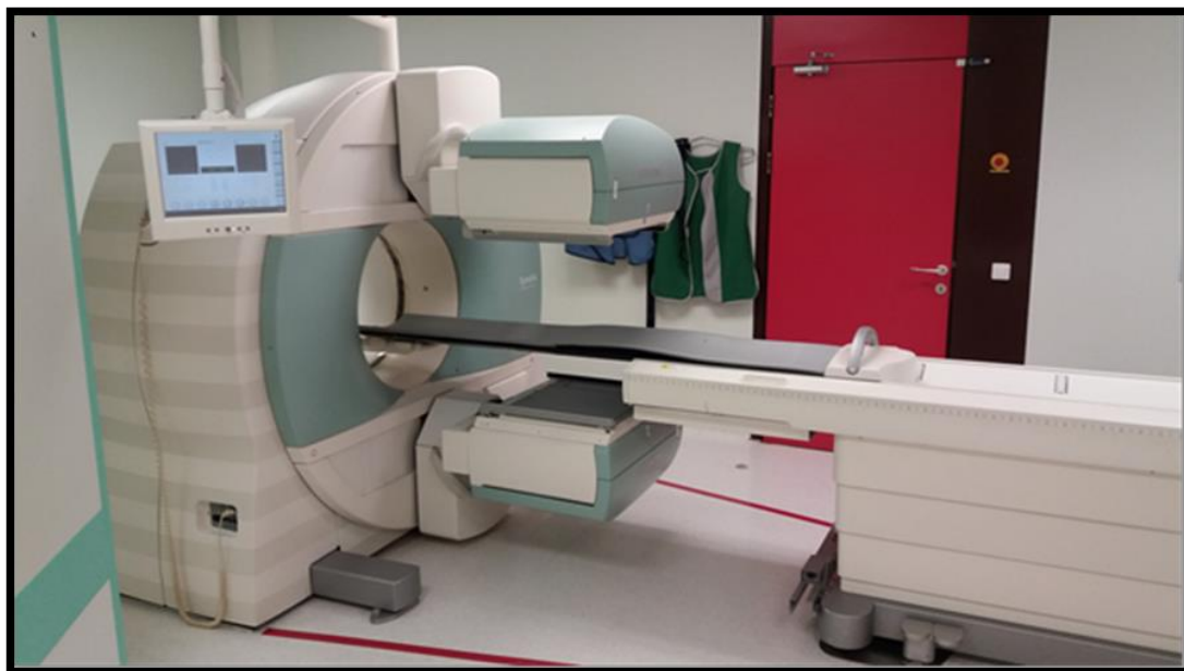
Slika 5: Hibridna enofotonska emisijska računalniška tomografska gama kamera in računalniška tomografija (SPECT/CT).
