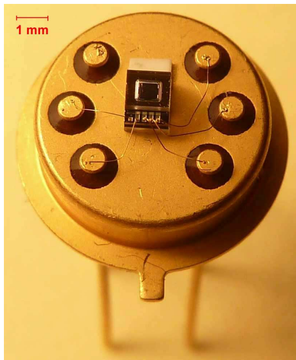
Sika 50: Silicijev senzor tlaka MS7204A nameščen na podnožju TO-39 ohišja.
