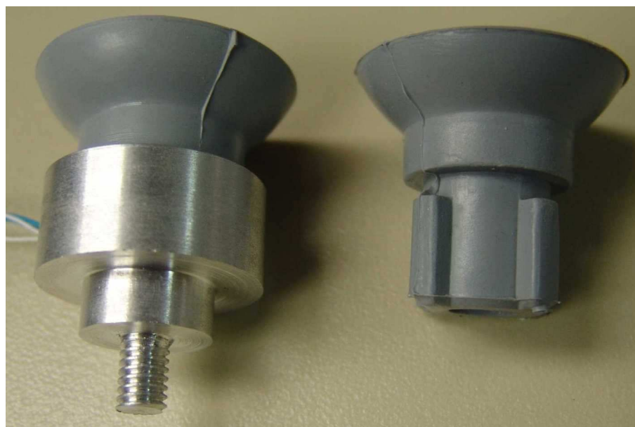
Slika 33: Hidravlične merilne celice vgrajena v nogico aparata v primerjavi z obstoječo gumijasto nogico.
