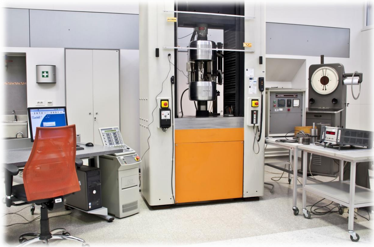
Slika 11: Univerzalni servohidravlični preizkuševalni stroj INSTRON 1255 (oprema z računalniškim sistemom INSTRON 8800 in programom Bluehill2) za dvostransko hladno stiskanje prekurzorjev.
