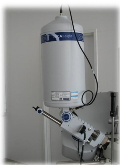
Slika 7: Energijskodisperzijski spektrometer (EDS) znamke INCA, Oxford Instruments.
