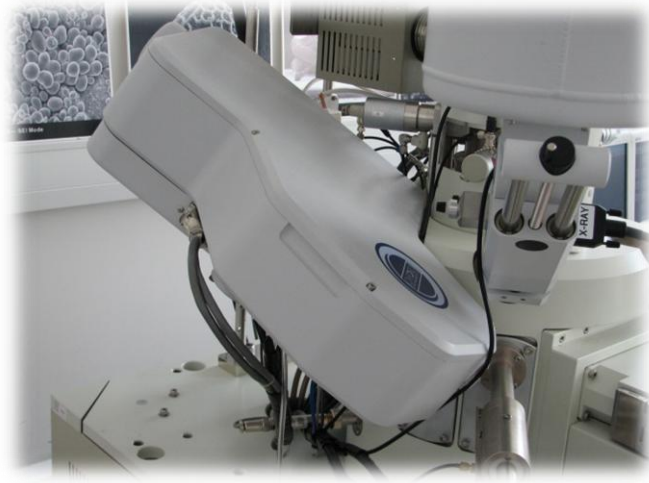
Slika 9: WDS detektor znamke INCA, Oxford Instruments.
