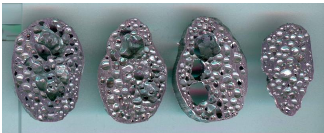
Slika 47: Prerezana pena (cela) iz AlSi12 + 0,5 mas. % \text{TiH}_2 , sintrana 3 min 20 s pri temperaturi 700 °C.
