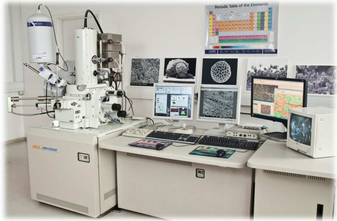
Slika 8: Vrstični elektronski mikroskop s Schottkyjevim izvorom elektronov opremljen z EDS in WDS analitskima tehnikama; sodobna izvedba elektronskega mikroskopa, JEOL JSM–6500F (Field Emission Scanning Electron Microscope) z računalniško podprtim sistemom.
